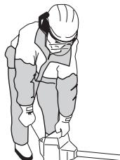
**TÄHELEPANU!** Ükski kehaosa ei tohi sattuda vastu märgistatud pinda. Kui süütekapsel on defektiga võib kontakti tulemuseks olla pöletushaav nahal või elektrilöök. Kasuta alati kindaid. Ära kunagi kasuta masinat, mille süütekapsel on defektiga.
