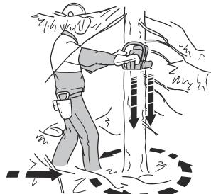
2. Eemaldage tööpiirkonnast puu ümber kasvav võsa. Eemaldage tööpiirkonnast köik saetud tükid.
