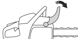
2. Velciet iedarbināšanas/apturēšanas slēdzi (A) uz āru un uz augšu, lai to novietotu gaisa vārstā pozīcijā.
